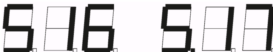
Рис. 3. 6. Сохранение программы. Под номером 16 ещё нет сохранённой программы (точка рядом с буквой «S» отсутствует). Под номером 17 уже имеется сохранённая программа (точка рядом с буквой «S» присутствует)
